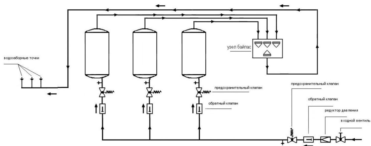
Схема обвязки водонагревателя с линией циркуляции
