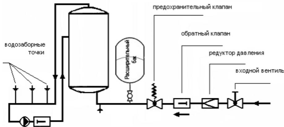
Схема обвязки водонагревателя с линией циркуляции
