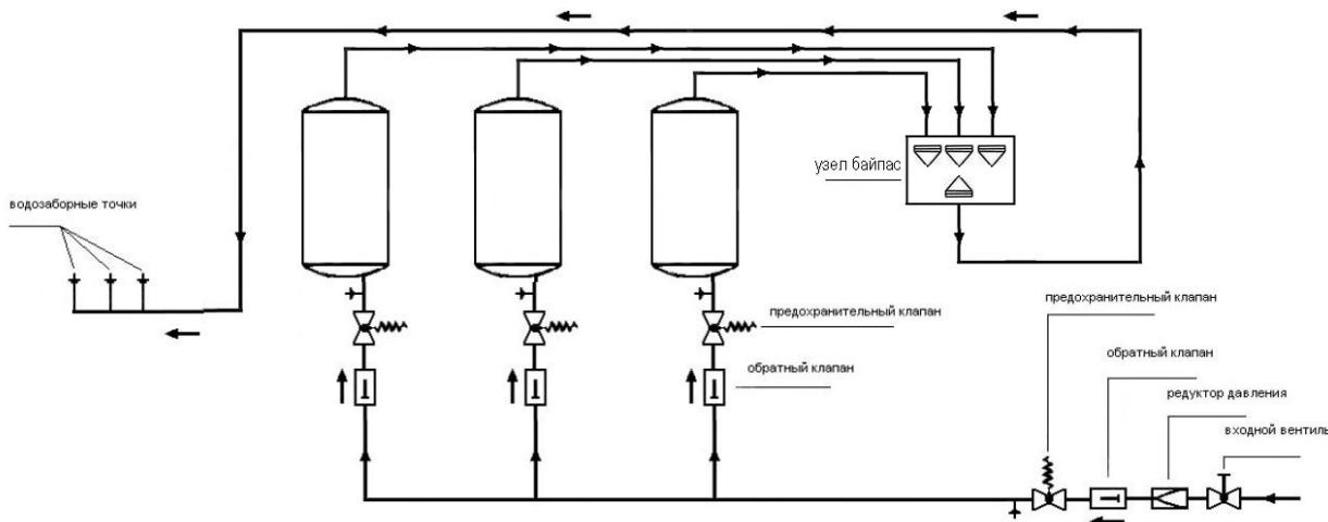
Схема обвязки водонагревателя с линией циркуляции
